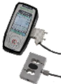
Oltre alle misure ergonomiche, se avete bisogno di utilizzare sensori per valutare la torsione di apertura sugli elementi di fissaggio, controllare la forza di compressione di una pressa meccanica o controllare la coppia dinamica su piccole parti rotanti per esempio, potete farlo con l'Ergokit Star utilizzando la sua uscita "SPIP".
